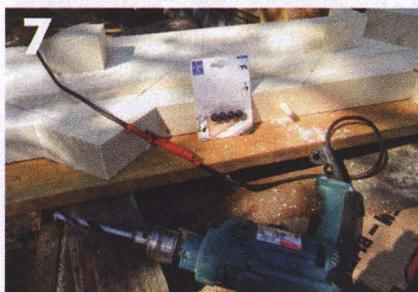
К заготовкам приклеивали не цельные бруски, а выкроенные из обрезков треугольные накладные элементы только в нужных местах. Для разметки ответных отверстий в деталях под шканты использовали металлические маркеры. Накладки крепили...
