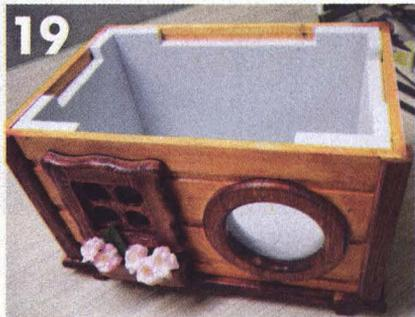
**19** В плитах утеплителя предусмотрел выборки под фиксирующие планки крышки.
