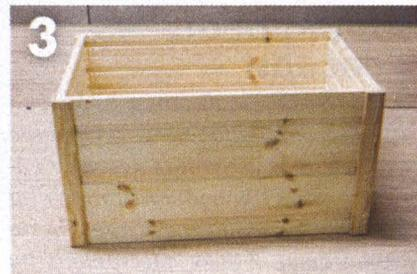
**3** Углы собранного короба усилил деревянными уголковыми профилями. Они ещё и дополнительная ветрозащита.
