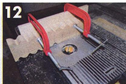
**12** Сначала в заготовке для кровельных реек профрезеровал поперечные полукруглые канавки.
