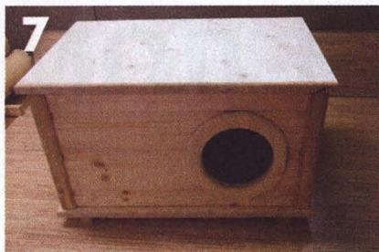
Крышка и основание имеют одинаковые размеры. И у того, и у другого скруглил только верхние рёбра на всех кромках.
