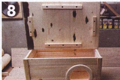
Фиксирующие рейки удерживают крышку на корпусе и не позволяют ей смещаться при случайном касании.
