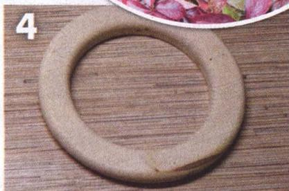
4. С лицевой стороны острые рёбра выпиленного из доски кольца, усиливающего стену в зоне круглого проёма-лаза, скруглил фасонной фрезой.
