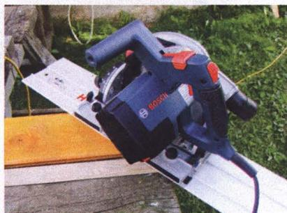
Подогнав по месту первый элемент обшивки из окрашенной шпунтованной доски, плотно стыковали с ним заготовку для следующего элемента. Используя скошенный торец готового элемента в качестве базовой поверхности, по линейке переносили разметку сначала на один край заготовки, затем на другой. Вдоль нанесённой на заготовку линии разметки крепили направляющую шину для дисковой пилы. Правильность установки шины дополнительно контролировали настроенной малкой.
